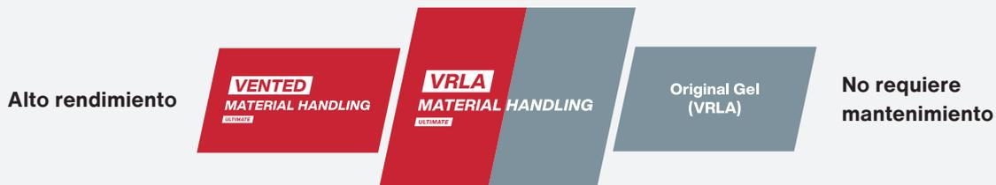
La tecnología VRLA Material Handling Ultimate ofrece una mayor capacidad disponible y un menor tiempo de recarga. Además, las celdas VRLA Material Handling Ultimate, minimizan la evolución de la temperatura en el interior de las celdas, aumentando así la eficiencia y la vida útil de la batería. Por su naturaleza sin mantenimiento no requiere agregar agua.
