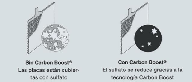
**Estratificación del ácido:** Las partículas de sulfato se convierten en ácido sulfúrico durante la carga. Es más pesado que el electrolito, por lo que se hunde en el fondo, creando con ello un abanico de efectos negativos, incluida una menor capacidad.
